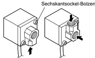
\* Der Pfeil zeigt die möglichen Druckanschlußpositionen.
